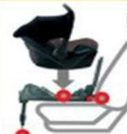
**Третья: стационарная система.** На сидение автомобиля стационарно устанавливается подставка под кресло, которая крепится в штатную систему изофикс и опирается на ногу- подставку,
